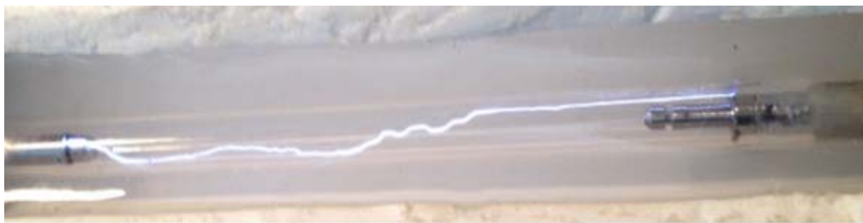
Рис. 2. Фотография одностримерного канала разряда в лампе с водяным охлаждением при ВЧ-накачке (3 МГц) с амплитудой около порога зажигания последовательностью пачки импульсов длительностью 1 мс
