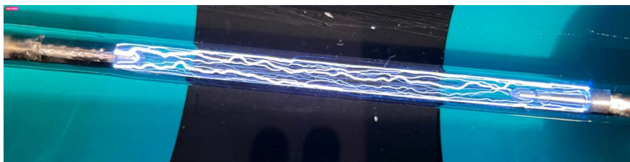
Рис. 3. Фотография многостримерного канала разряда в лампе с водяным охлаждением при ВЧ-поджиге (1,5 МГц) с амплитудой около порога зажигания последовательностью пачки импульсов длительностью 25 мкс. P = 35 кВт
