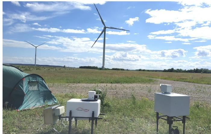
Рисунок 2 – Фото с места проведения эксперимента на территории ветропарка в Ульяновской области, снятое во время работы лидаров ЛРВ-1 (справа) и Stream Line (слева).
