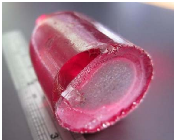
Рис. 2. Монокристалл GaSe 1-x S x , x = 0,2 с минимальной эвтектикой и местом отслоения части кристалла на переднем плане
